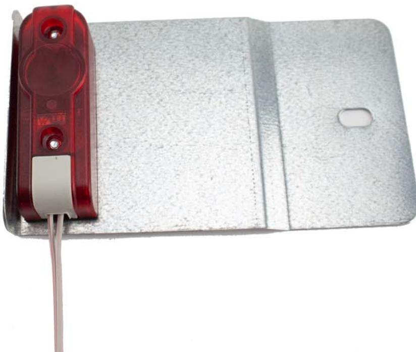
Sollte dann fertig so aussehen. Kann nun so an der Zarge vom Tor Rechts und links befestigt werden
