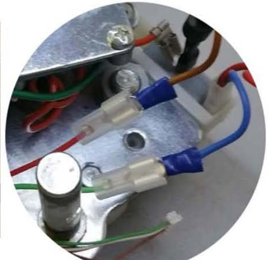
die beiden mit gelieferten Flachstecker aufquetschen
