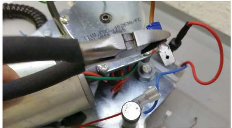
die beiden mit gelieferten Flachstecker aufquetschen
