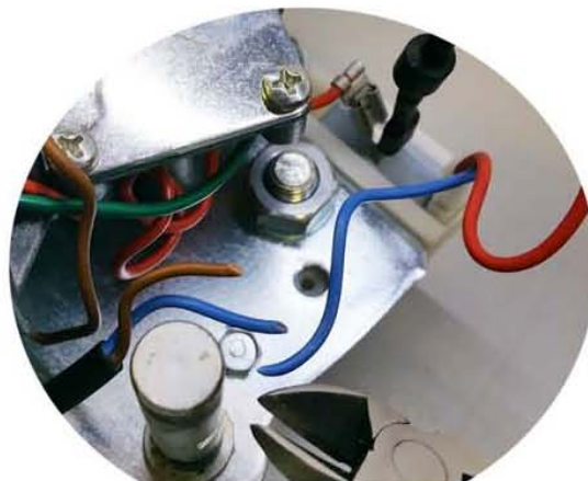
blaues Kabel durchtrennen (vom schwarzen Spiralkabel)
