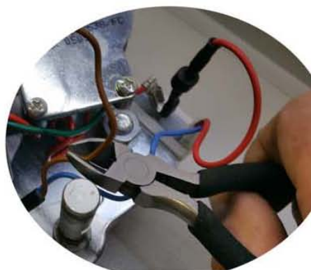
braunes Kabel durchtrennen (vom schwarzen Spiralkabel)
