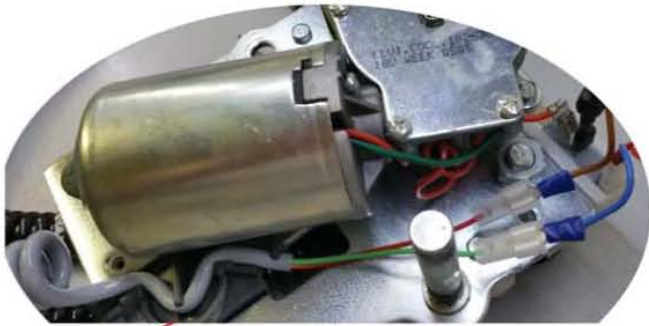
Das Neue Kabel durch die Zugsicherung führen
