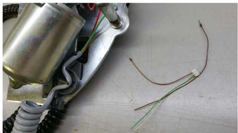
die nicht benötigten dünnen Kabel abtrennen
