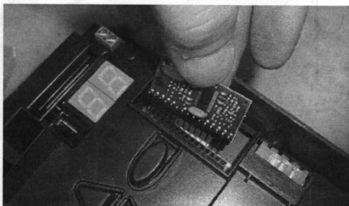
Plaats de ontvanger module met de elektronica componenten naar de drukknopen toe in de insteek connector. Let op dat de pennen goed geplaatst zijn.
