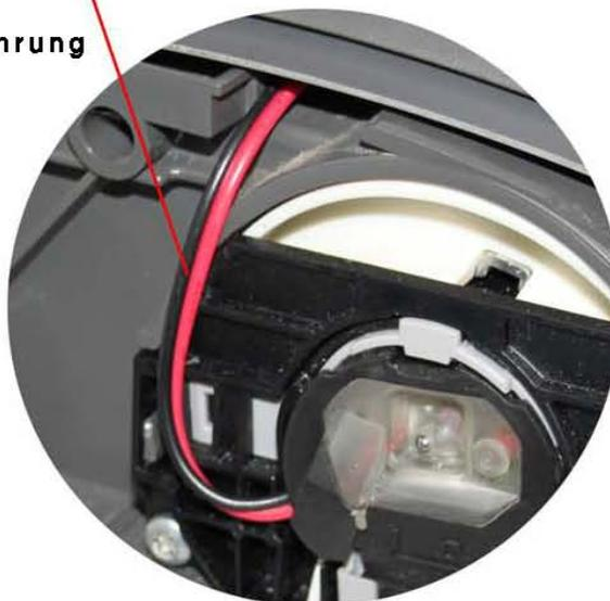
Das Kabel wird im Original von unten in den Motor eingeführt.
