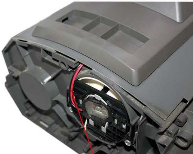
Kabel mit dem Stecker vom Solarpanel durch das erstellte Bohrloch durchführen und in die Buchse vom Motor einstecken.
