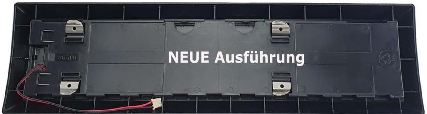
beim Verbindungs-Kabel ist zu beachten das dieses kürzer ist. Somit kann die Ursprüngliche Kabelführung nicht mehr ausgeführt werden. Lässt sich aber ausführen.
