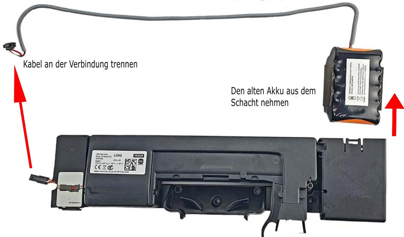
Kabel an der Verbindung trennen
